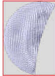
図 3 ステータ部キャビティ PTV 流動解析結果
