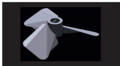
HR100 インペラは、翼平面形状及び迎え角、カンバー比に対して検討を加え、翼先端ねじり下げ多段折り曲げ構造とし、翼背面における剥離を抑制することにより、低動力にて高吐出性を誇る省エネルギータイプの低剪断型軸流攪拌翼です。液-液混合、固-液分散、潰れやすく重くない粒子や、乳化マイクロカプセル（ラテックス etc.）の均一懸濁に適するとともに、優れた軸方向流動化作用を用い、多段攪拌における組み合わせにもその特性が発揮されます。
