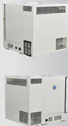
パーフュージョンシステム TCS、CSS II を使用時に培地温度を低温で一定に保つことができるインキュベータです。ラインナップとしてラボ用のみならず細胞培養調整施設 (CPC) 用の2つを揃えています。培地想定温度表示機能があり、他インキュベータよりも精密に温度管理ができます。培地ストレージ容器は 10L マルチパーパスバッグまで収納可能です。
