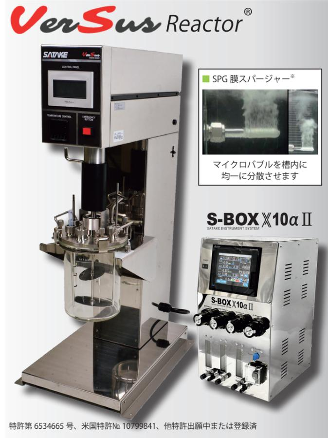
VerSus Reactor は、VMF Reactor と、極めて均一性の高いマイクロバブルを発生させることができる『SPG 膜スパージャー<sup>®</sup>』の技術を融合させた、今までにない新しい動物細胞培養用バイオリアクターです。SPG 膜スパージャーによる効率的な酸素供給により、培養槽内の動物細胞にストレスを与えることなく効率的に酸素を供給できます。また、DO 通気流量の低減により泡沫層を抑制します。専用コントローラ『S-BOX × 10 α II』により、DO、pH の制御が可能です。また、アナログ出力をデータロガーに入力し、記録することができます。
