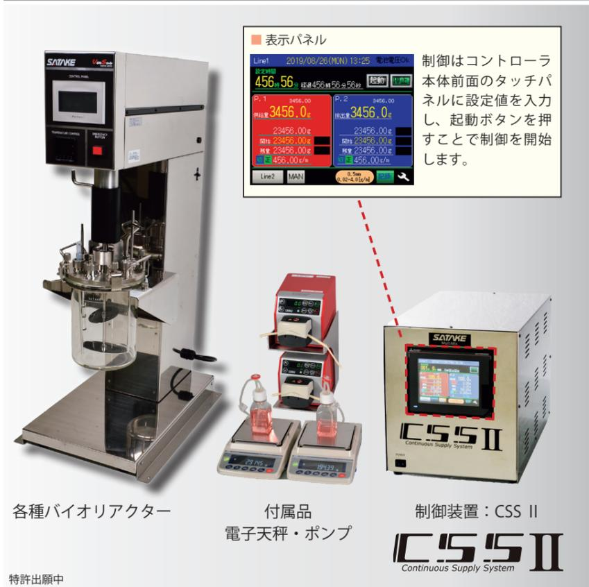
培養槽内の培地交換は、制御装置（CSS II）に設置した電子天秤と送液ポンプを用いて、設定した時間・重量での培地供給と培地排出を同時に行います。送液ポンプは設定時間・ポンプ流量値（使用するチューブ径を選択）及び電子天秤の現在重量値から自動的に最適な回転数が算出され、指定時間まで動作を行います。また、制御中は100ms毎に天秤の重量を監視し、ポンプの回転数が自動的に可変します。指定時間に到達すると制御は自動的に停止します。標準ポンプは付属品として、医薬品製造現場および培養実験室において、一般的に採用されているポンプ：Watson-Marlow（株）の“120U/DV analogue control variable speed pump”、電子天秤：（株）A&Dの“GX3002A”を標準品として採用しております。
