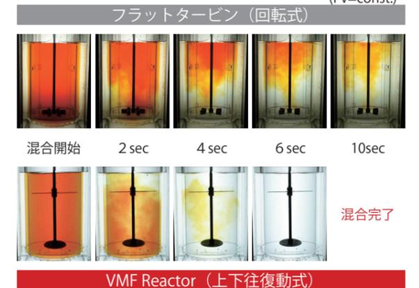
CFD シミュレーション解析結果より、VMF Reactor(上下往復動式)は回転式と比較して培養槽内の剪断応力の均一性が高いことが判ります。また、同一エネルギー条件下における均一混合性能は回転式と比較して VMF Reactor は極めて優れていることが判ります。
