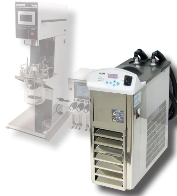
クールエースは冷凍機により付属貯水槽内の液を冷却し、外部循環を行い、エバポレーター (1L)、培養槽、反応槽、各種分析機器・機械装置の発熱部等の冷却ができる冷水循環装置です。
