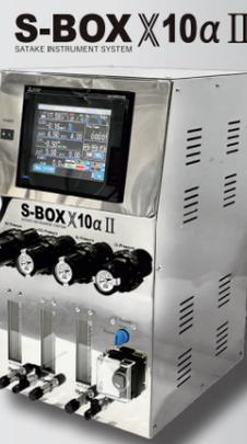
MRF Reactor は、実生産やスケールアップを目的としたラボ用バイオリアクターです。実設備で重要な“洗浄性に優れたシンプルな形状”に加え、優れた混合・均一性を発揮する『培養専用インペラ MR210Bio』を標準装備し、スケールアップの際もラボスケールと同様の培養結果を再現できます。また、液面変動(フェッドバッチ培養)に対応し、あらゆる液量でも変わらない攪拌性能を発揮します。1.5Lの小容量から 20,000L の大容量まで対応可能です。専用コントローラ『S-BOX × 10 α II』により、DO、pHの制御が可能です。また、アナログ出力をデータロガーに入力し、記録することができます。
