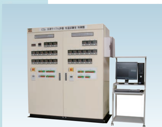
CO 2 熱交単体試験装置 冷凍サイクル本体及び恒温水槽と風量測定装置を収納した試験室で構成されています。 CO 2 Heat-exchanger Testing Equipment The test chamber contains a refrigeration cycle unit, a constant-temperature water bath and an air-flow measuring apparatus.
