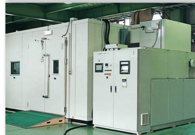
用途: 事務機ペーパーハンドリング試験用 等 Use: Testing office equipment paper handling, etc.
