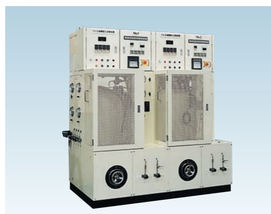
CO 2 用圧縮機寿命試験装置 CO 2 Compressor Life Testing Equipment
