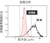
・スラリー中の微粒子の分級 粒子径0.5 μ m ~ 20 μ m 程度
