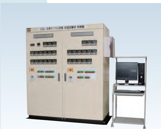
CO 2 熱交単体試験装置 冷凍サイクル本体及び恒温水槽と風量測定装置を収納した試験室で構成されています。 CO 2 Heat-exchanger Testing Equipment The test chamber contains a refrigeration cycle unit, a constant-temperature water bath and an air-flow measuring apparatus.
