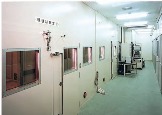
用途: ルームエアコン熱負荷試験用等 Use: Testing room air conditioner thermal load, etc.
