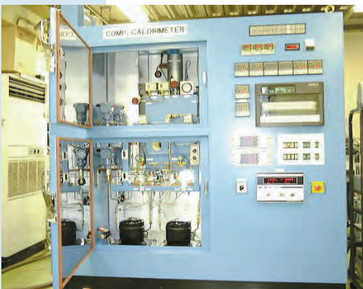
R600a冷蔵庫用圧縮機カロリーメーター R600a Compressor Calorimeter for Refrigerators
