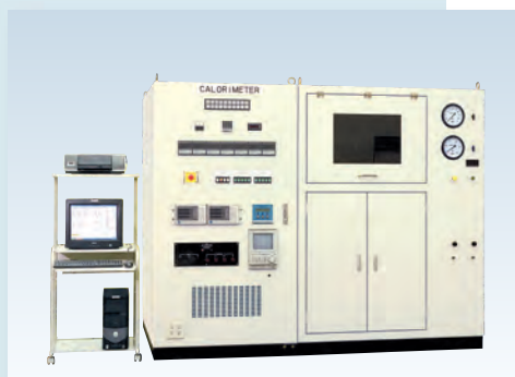
二次冷媒圧縮機カロリメータ Secondary Refrigerant Compressor Calorimeter
